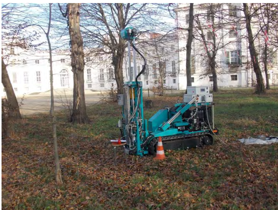
Foto 2 - Prova Penetrometrica Dinamica Pesante SCPT P1
