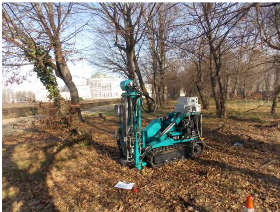
Foto 3 - Prova Penetrometrica Dinamica Pesante SCPT P2
