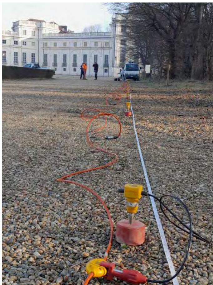
Foto 4-5 - Indagine sismica MASW
